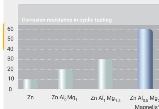
10 µm du revêtement soumis à des cycles alternés cycle de brumisation de 8 heures (5% NaCl) / cycle sec / cycle d'humidité.
